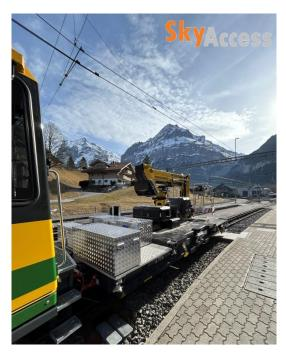
La JR1050 EVO a été spécialement conçue pour être montée sur un wagon de marchandises freiné en fonction de la charge (wagon porteur modulaire) par la société Ferdinand Steck Maschinenfabrik AG et convient parfaitement à l'entretien des installations ferroviaires et des lignes électriques aériennes des chemins de fer à crémaillère.
